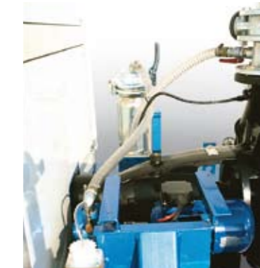
RIEMPIMENTO AUTOMATICO ASPIRAZIONE. Depressore azionato da motore elettrico che permette di riempire il tubo di aspirazione.
