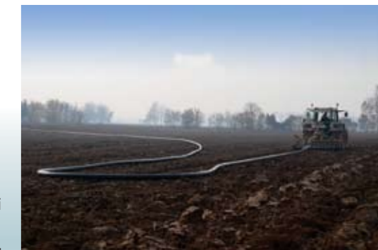
Il tubo in polietilene segue senza schiacciarsi il percorso del trattore che si muove nel campo.
