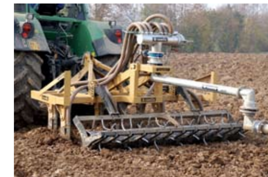
Tramite l'impianto sotterraneo e l'irrigatore CASELLA, il ripper viene alimentato in continuo dal liquame.
