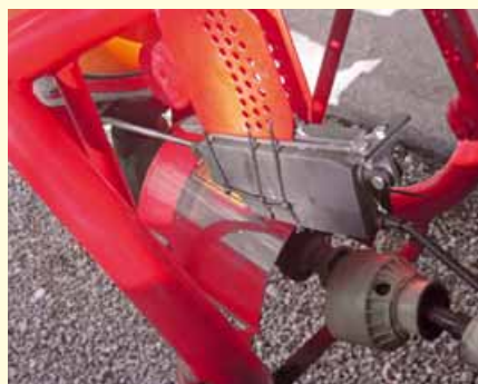
Foto B Particolare dell'attuatore elettrico montato su un fertilizzatore tradizionale
