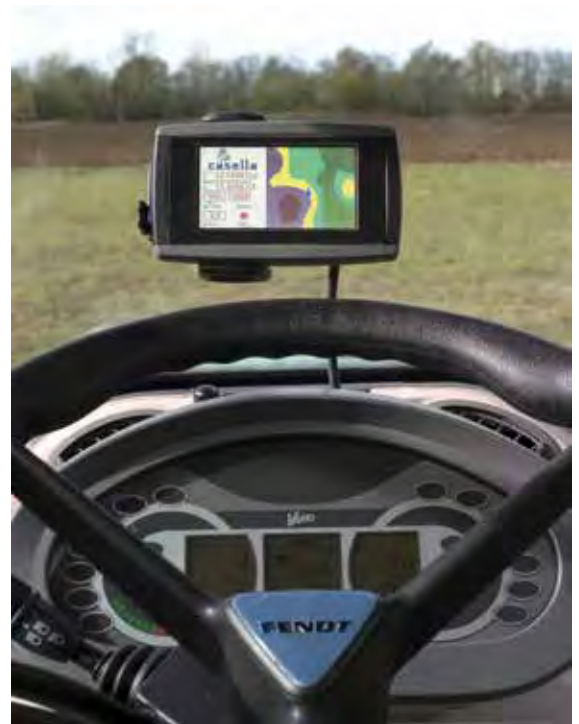
La centralina Ripper Sat che controlla la velocità di avanzamento del trattore è montata direttamente in cabina
